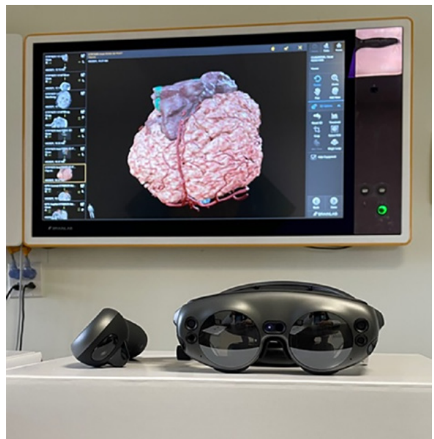
Figura 2. Visor de realidad mixta. Este consiste en una pantalla táctil similar a la de un televisor con el software Element Viewer (en la parte posterior), y Magic Leap Goggles and Control que le permiten ver e interactuar con las proyecciones 3D creadas por el software .
